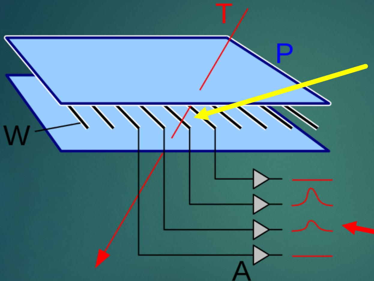
Una particella carica ionizza il mezzo che attraversa producendo cariche elettriche libere di muoversi
