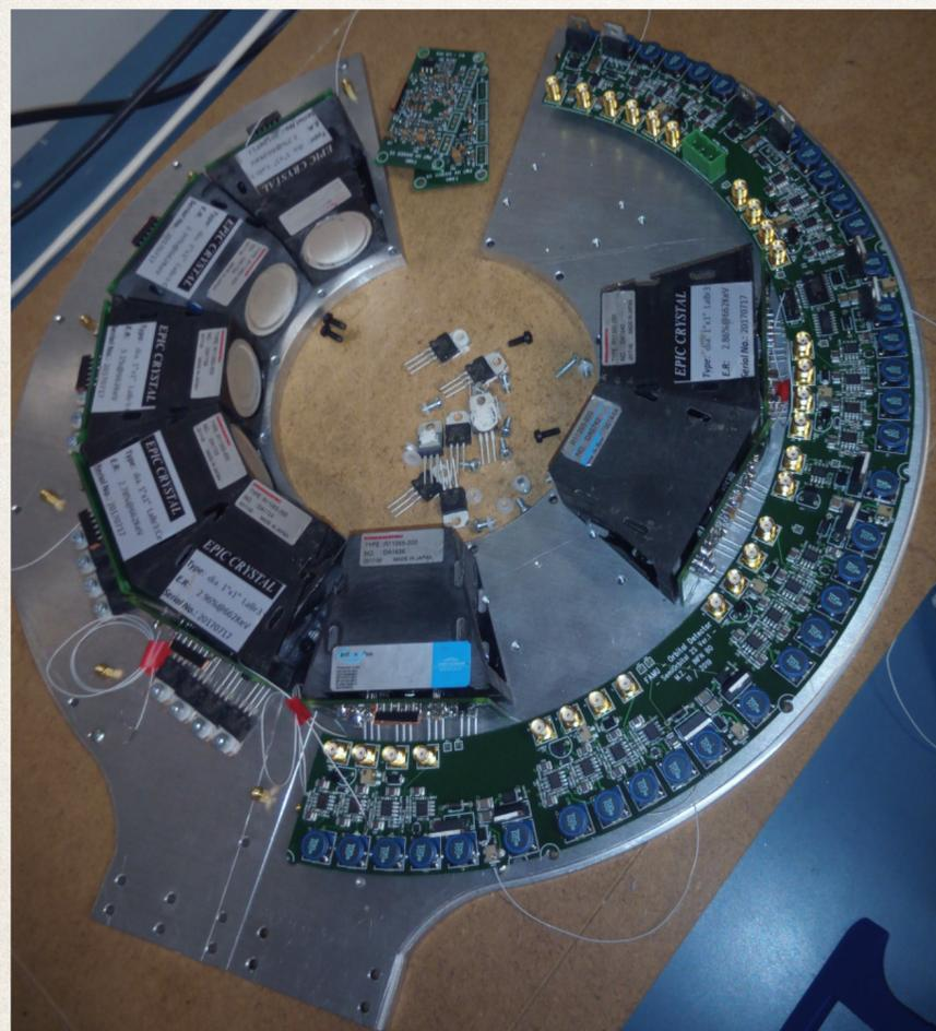
Assemblaggio delle schede Orbital Detector con i PMT per il front-end di FAMU
