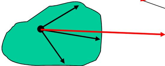
*Sostituzione di un insieme di vettori applicati in un punto con la loro risultante, applicata nello stesso punto.*
