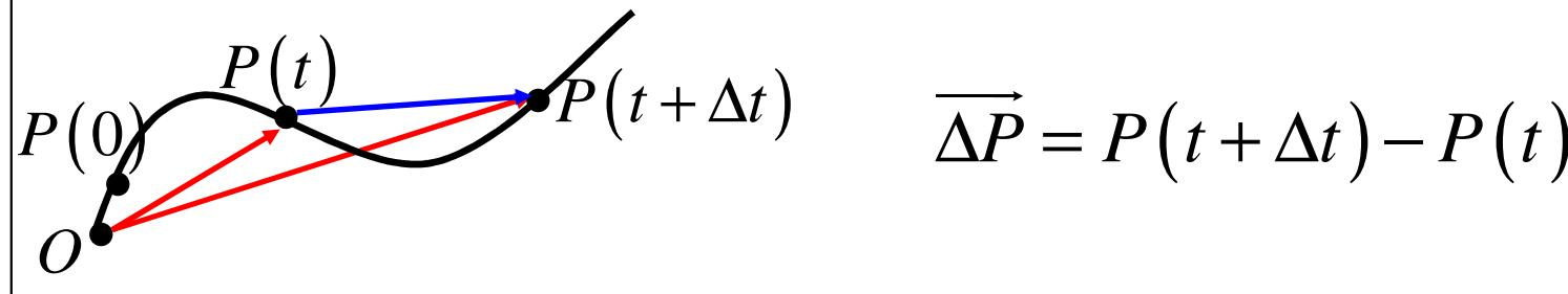
**Velocità media vettoriale**  $\vec{v}_m(t) = \frac{\overrightarrow{\Delta P}}{\Delta t} = \frac{P(t + \Delta t) - P(t)}{\Delta t}$
