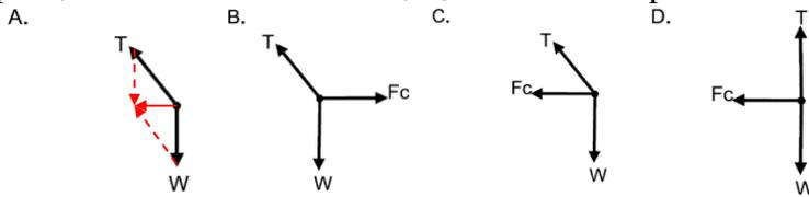
*Schema A: la forza peso e la tensione della fune si sommano vettorialmente in modo da produrre la forza centripeta orizzontale responsabile del moto circolare della sfera.*
