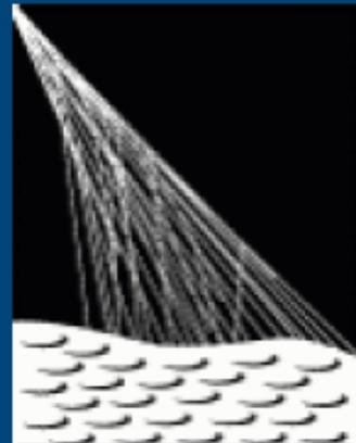
**La collisione di particelle primarie di alta energia con le molecole dell'aria produce una cascata di particelle secondarie che arriva fino alla quota di osservazione.**
