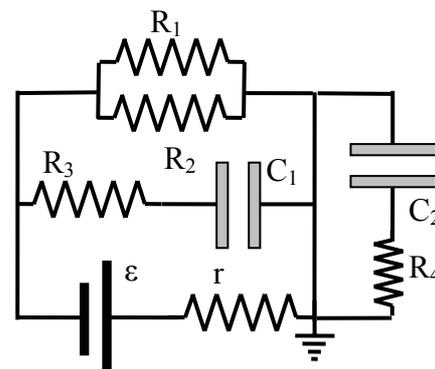
6) Si consideri il circuito mostrato in figura composto da due condensatori di capacità  $C_1=2\mu\text{F}$  e  $C_2=1\mu\text{F}$ , da quattro resistenze  $R_1= 20\Omega$ ,  $R_2=40\Omega$ ,  $R_3=20\Omega$ ,  $R_4= 10\Omega$  e da un generatore di resistenza interna  $r=10\Omega$  che fornisce una forza elettromotrice  $\varepsilon=100\text{V}$ . Determinare in regime stazionario:
