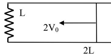
campo di induzione magnetica variabile  $|\vec{B}| = K_0 t$  diretto perpendicolarmente al piano in figura in verso uscente ( $K_0$  è una costante positiva nota). Inizialmente l'asta si trova ad una distanza  $2L$  dal conduttore fisso e si muove con velocità  $2V_0$  costante verso destra. Determinare:
