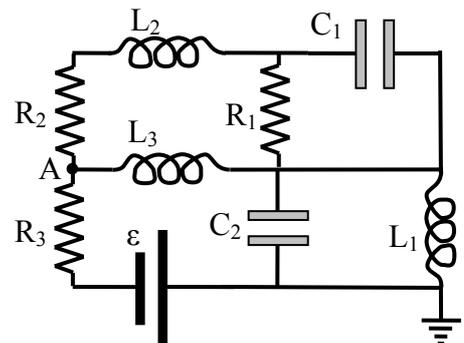
41. Si consideri il circuito mostrato in figura composto da tre induttanze  $L_1=L_2=L_3=2L$ , da tre resistenze  $R_1=R_2=R_3=R$ , da un generatore di resistenza interna trascurabile che fornisce una forza elettromotrice  $\varepsilon$ , da un condensatore di capacità  $C_1=C$  e da un interruttore T inizialmente aperto. Determinare:
