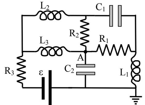
40. Si consideri il circuito mostrato in figura composto da tre induttanze  $L_1 = L_2 = L_3 = L$ , da tre resistenze  $R_1 = R_2 = R_3 = 2R$ , da un generatore di resistenza interna trascurabile che fornisce una forza elettromotrice  $\varepsilon$  e da due condensatori di capacità  $C_1 = C_2 = 2C$ . Determinare in regime stazionario:
