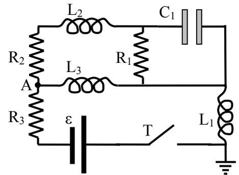
42. Si consideri il circuito mostrato in figura composto da tre induttanze  $L_1=L_2=L_3=2L$ , da tre resistenze  $R_1=R_2=R_3=2R$ , da un generatore di resistenza interna trascurabile che fornisce una forza elettromotrice  $\varepsilon$ , da un condensatore di capacità  $C_1=C$  e da un interruttore T inizialmente aperto. Determinare:
