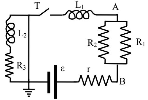
38. Si consideri il circuito mostrato in figura composto da due induttanze  $L_1 = L_2 = L$ , da tre resistenze  $R_1 = R_2 = R_3 = R$ , da un generatore di resistenza interna  $r = R/2$  che fornisce una forza elettromotrice  $\varepsilon$  e da un interruttore  $T$  inizialmente aperto. Determinare:
