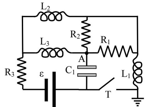
43. Si consideri il circuito mostrato in figura composto da due induttanze  $L_1=L_2=2L$ , da tre resistenze  $R_1=R_2=R_3=3R$ , da un generatore di resistenza interna  $r=R/2$  che fornisce una forza elettromotrice  $\varepsilon$  e da un interruttore T inizialmente aperto.
