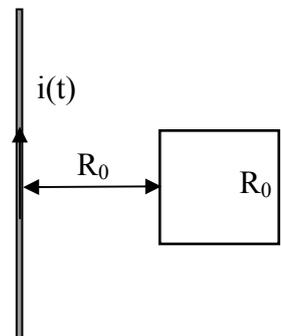
5. Una spira rettangolare di lati  $R_0$  e  $2R_0$  è posta ad una distanza  $R_0$  da un filo indefinito percorso da una corrente variabile nel tempo secondo la relazione  $i(t) = i_0 \sin(\omega t)$  (vedi figura). La spira ha sezione  $S$  e resistività  $\rho$ , determinare:
