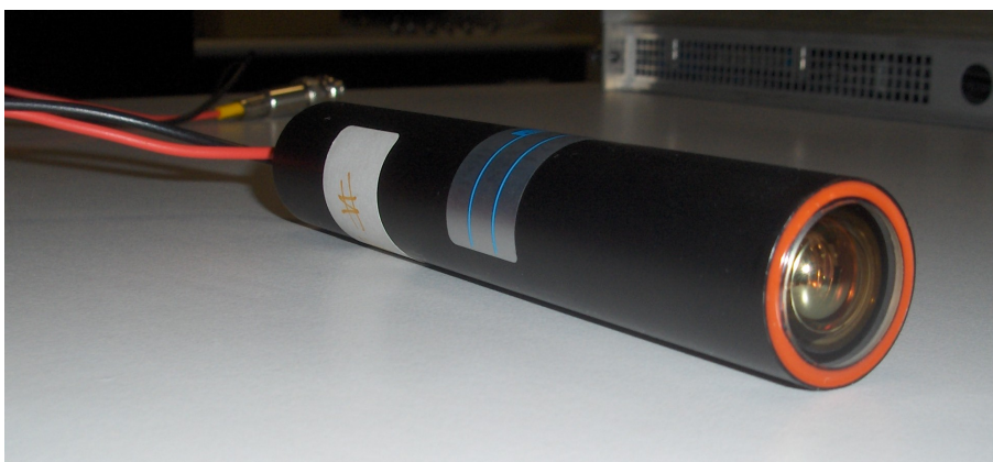
Figura 2.16: Il fotomoltiplicatore usato per le misure.
