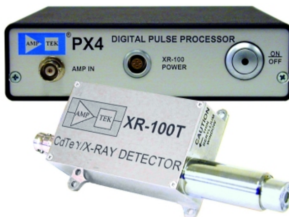
Figura 5.2: Il rivelatore Cd-Te utilizzato.
