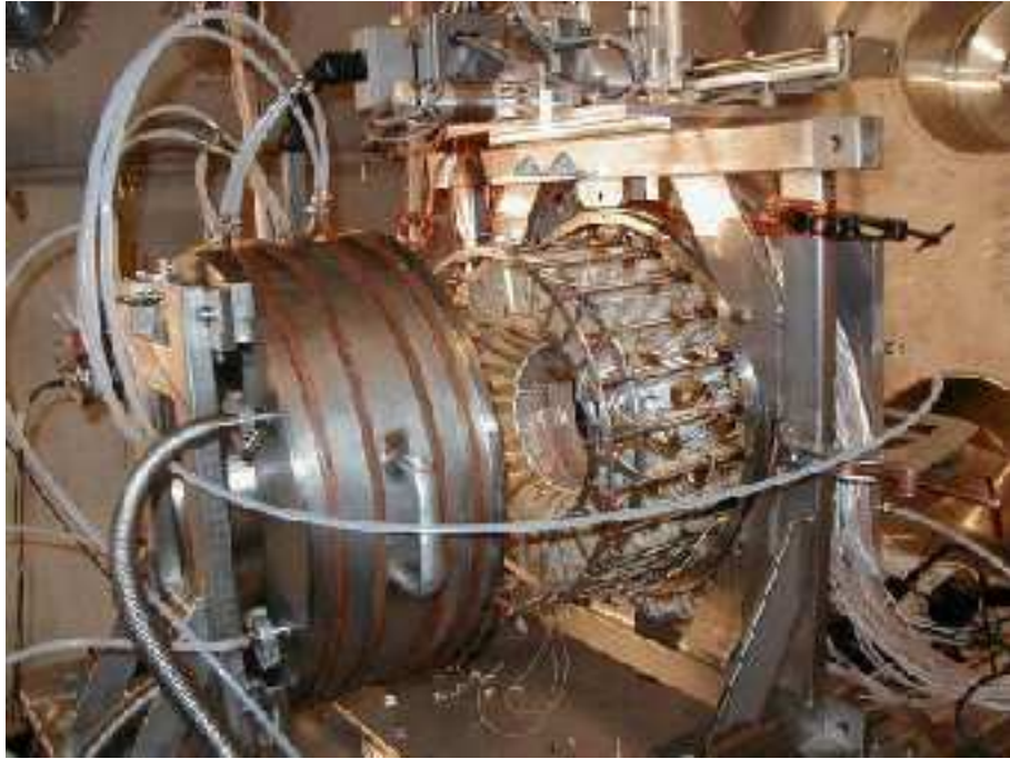
Figura 2.2: Camera C1 aperta. è visibile il partitore dove sono posizionati i cristalli CsI(Tl).
