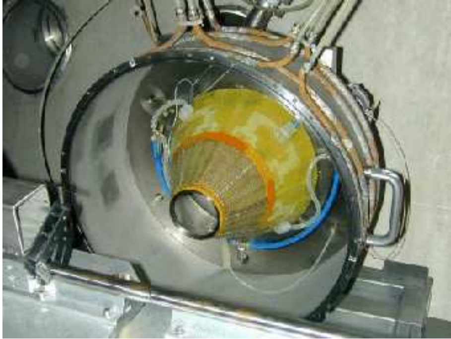
Figura 2.10: Cono disposto sul coperchio della camera C1, il quale ha la duplice funzione di formare il catodo di deriva e di distribuire il gas nella camera.
