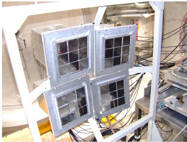
Figura 2.9: Vista frontale (dalla direzione di incidenza del fascio) dei 32 rivelatori PHOSWICH posizionati nelle 4 matrici di sostegno.
