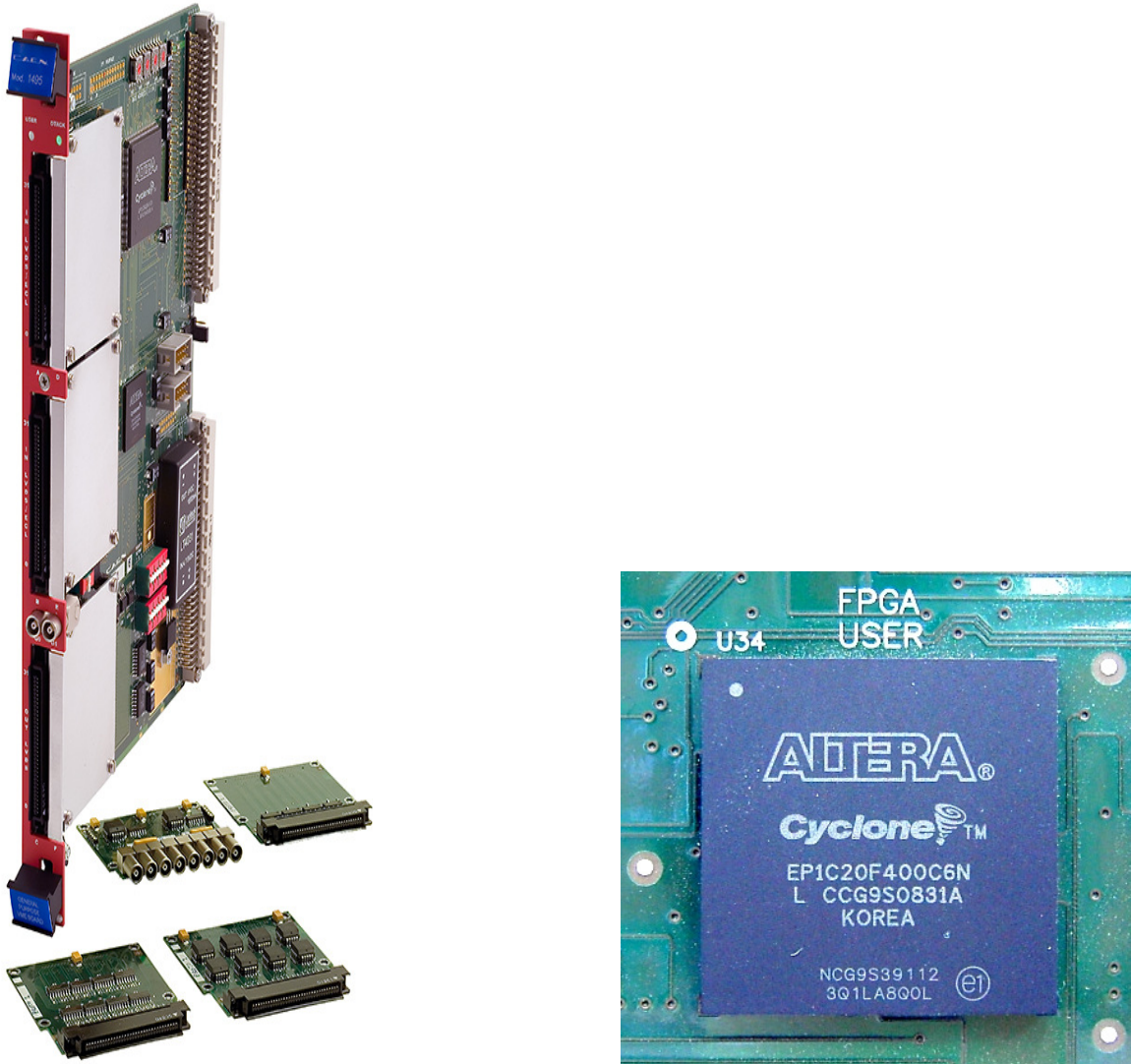
fig 2.5 Scheda CAEN V1495 (a sinistra) e FPGA EP1C20F400C6 della famiglia Cyclone ALTERA (a destra).
