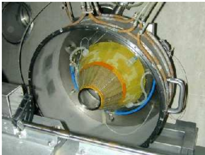
Figura 2.10: Cono della camera C_1 , che forma il catodo di deriva della camera e rende il campo uniforme. Notiamo inoltre la sua ulteriore funzione di immettere nuovo gas attraverso dei tubi.
