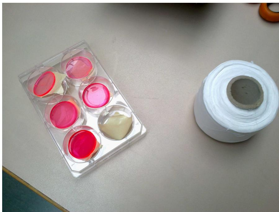
**Figura 4.2:** Immagine relativa ad alcuni campioni utilizzati dal tipico colore rossiccio dovuto alla diversa concentrazione di Lumogen®Red. A destra è anche visibile il nastro Teflon utilizzato per gli accoppiamenti PMT-scintillatore e APD-scintillatore.
