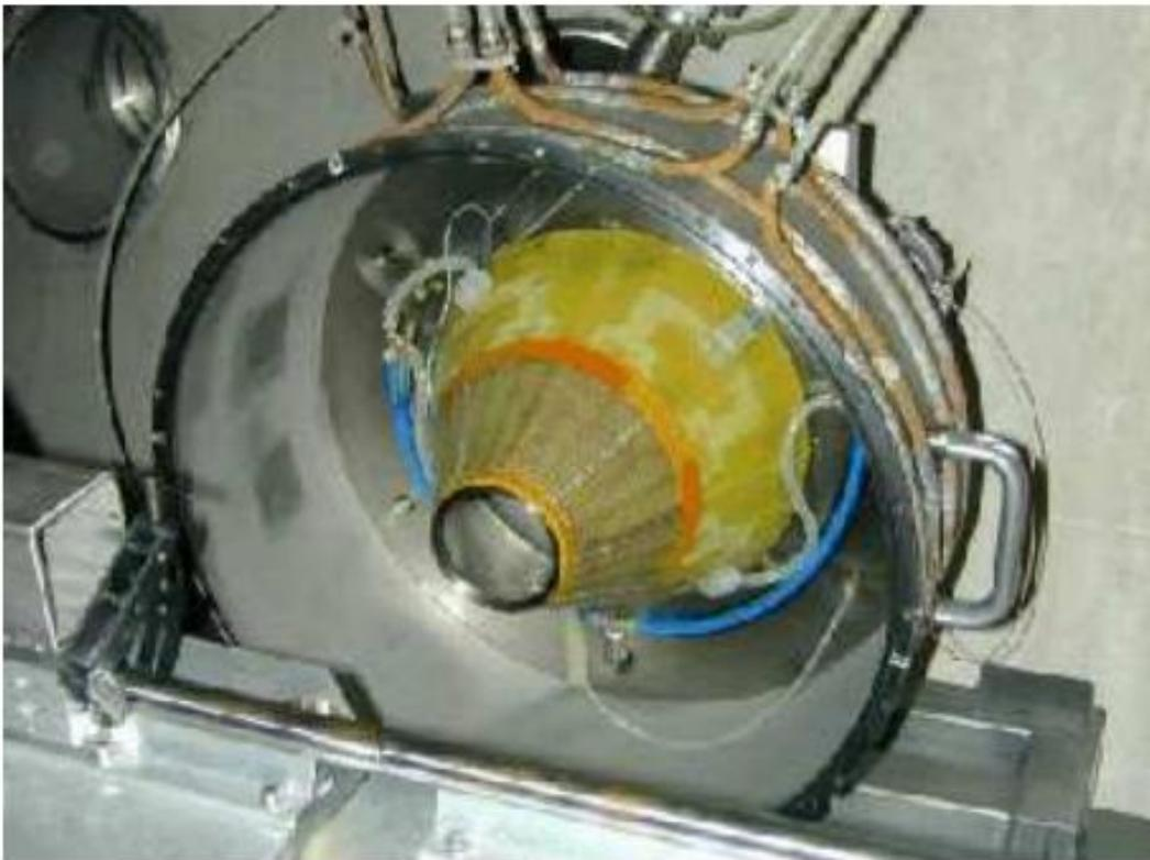
*Figura 2.4.1.1: Cono della camera C1 che ha la duplice funzione di formare il catodo di deriva della camera a microstrip e rendere il campo uniforme. Sudi esso, inoltre, si notano i due tubi per il ricircolo del gas.*
