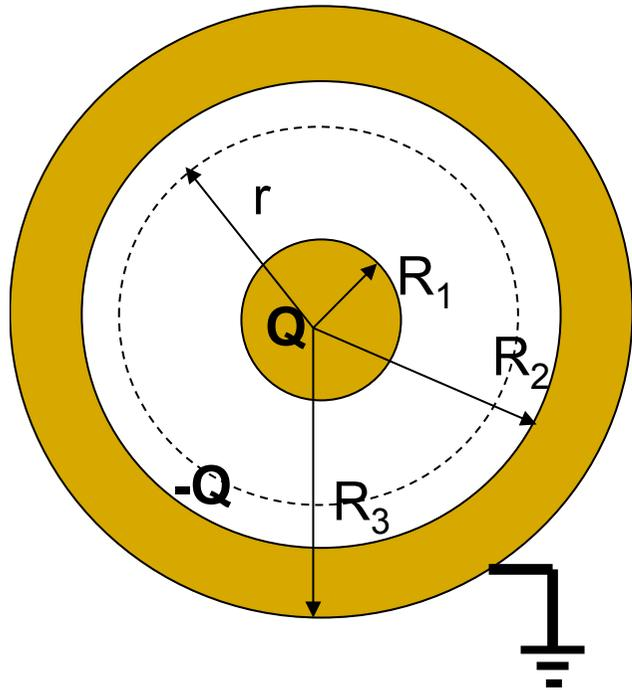
Carica  $+Q$  e  $-Q$  sulle superficie di un condensatore sferico ai raggi  $R_1$  e  $R_2$
