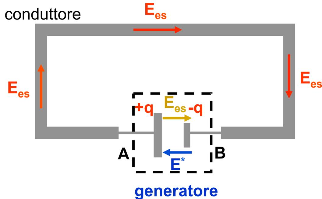
Dentro al generatore una carica  $dq$  viene spostata da B verso A da una forza  $d\vec{F}^*$  che deve vincere la forza elettrostatica  $d\vec{F}_{es} = dq\vec{E}_{es}$
