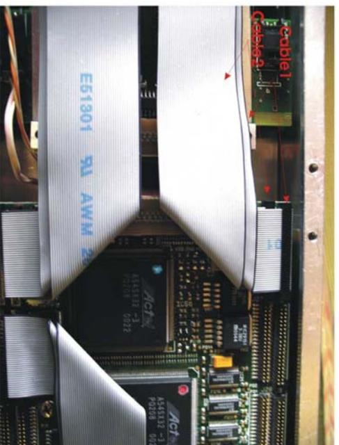
Figura 13: Connessioni e disposizione dei cavi di trigger: particolare.
