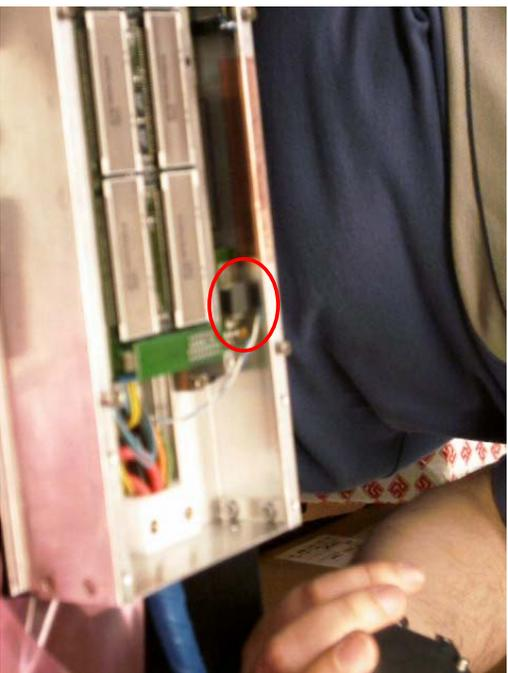
**Figura 9: Gomma termococonduttiva sui regolatori di tensione della TRB.**
