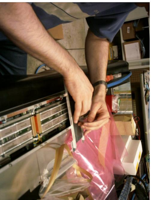
Figura 8: Aderimento della gomma termococonduttiva.
