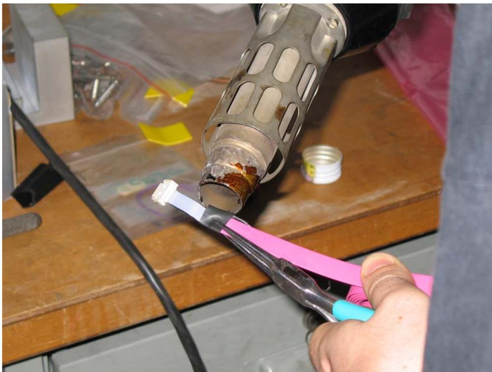
**Figura 5:** particolare della procedura di restringimento della gomma termorestringente
