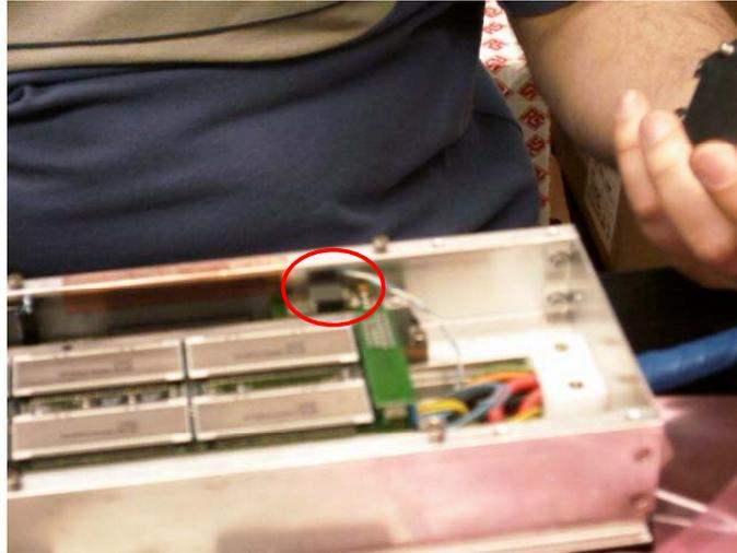
**Figura 12: Gomma termoconduttiva sui regolatori di tensione della TRB.**
