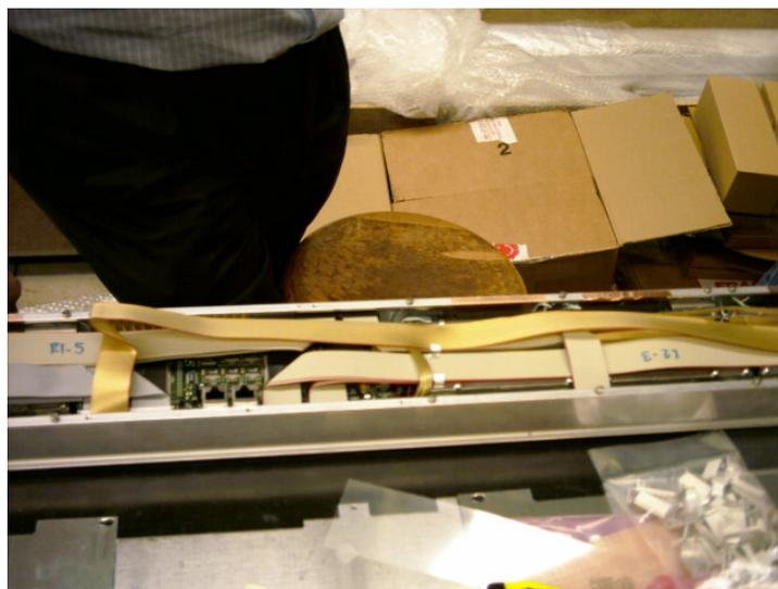
**Figura 19: Routing del cavo Link sopra la SB.**
