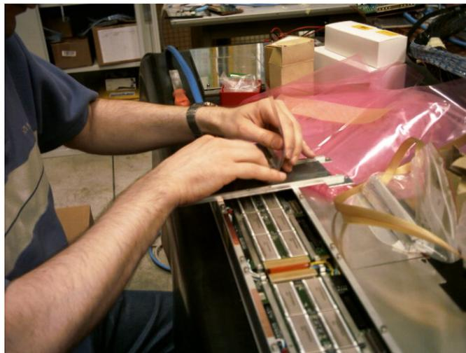
**Figura 11: Aderimento della gomma termoconduttiva.**
