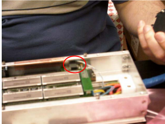
Figura 9: Gomma termoconduttiva sui regolatori di tensione della TRB.
