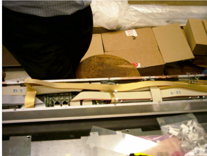
Figura 16: Routing del cavo Link sopra la SB.
