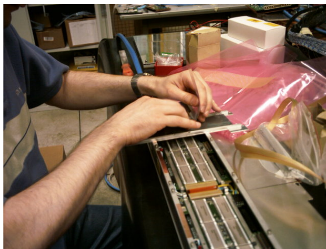
Figura 8: Aderimento della gomma termoconduttiva.
